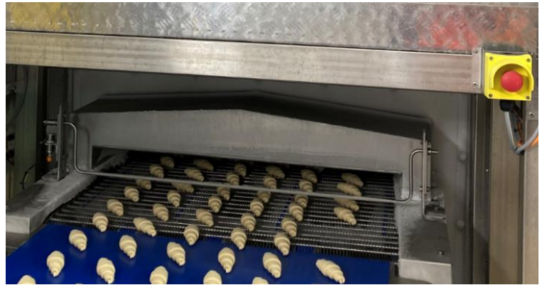
Figure 10 : Léger givrage en sortie surgélateur qui montre une bonne maîtrise
